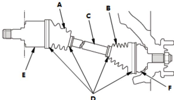
1. 检查半轴 (C) 上的内防尘罩 (A) 和外防尘罩 (B) 是否破裂、损坏、漏脂，以及罩箍是否松动 (D)。如果发现任何损坏，更换防尘罩和罩箍。
